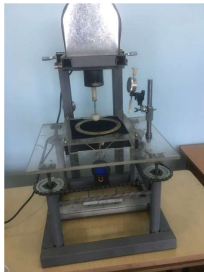
Рисунок 1. Установка для циклического деформирования пакета со швом (а- схема установки, б- фотография установки)
