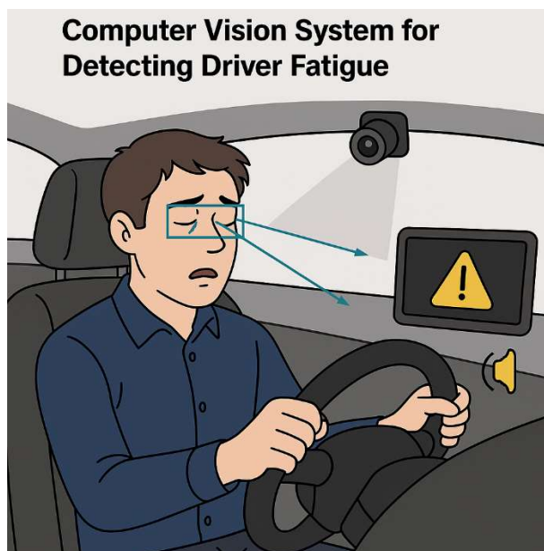
Сурет 2. Жүргізушінің шаршауын анықтауға арналған компьютерлік көру жүйесінің иллюстрациясы
