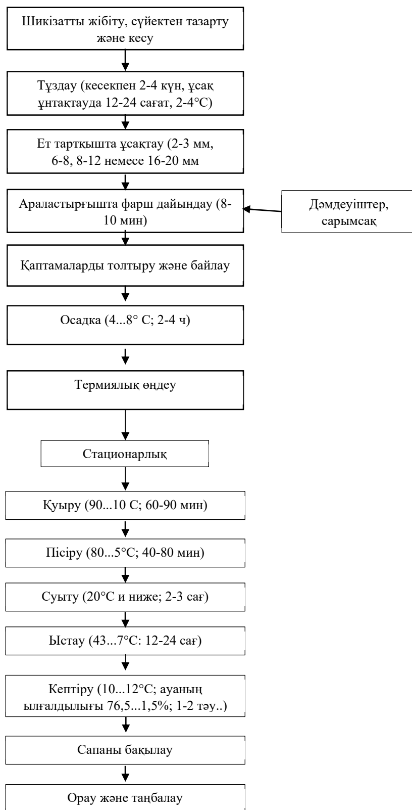
Сурет 1 – «Алтай» жартылай ысталған шұжық өндірісінің технологиялық схемасы
