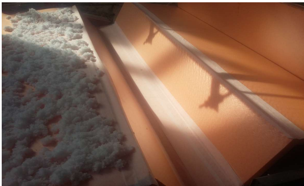
Сурет 4 – Пеноплекстен жасалынған трапеция қималы арна
